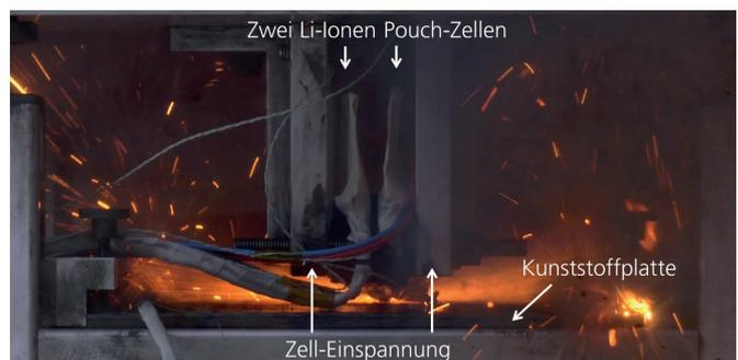
Thermisches Durchgehen von Pouch-Zellen, experimentelle Untersuchung zur Wirkung auf Kunststoffstrukturen. © Fraunhofer EMI
