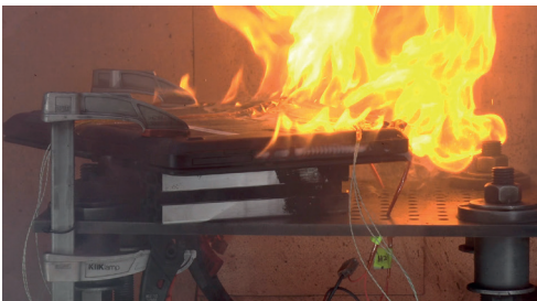
Ein Laptop brennt während des thermischen Durchgehens. © Fraunhofer EMI
