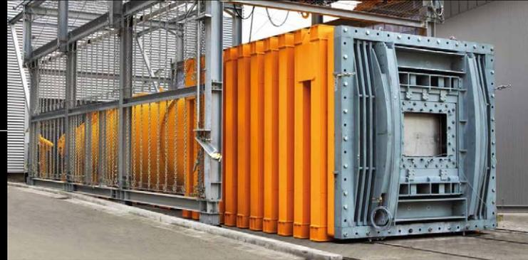
**Materialien und Strukturen resilienter gestalten:** Mit einer der weltweit größten Stoßrohranlagen können Stoßwellenbelastungen infolge von Sprengstoff- und Gasexplosionen simuliert werden.
