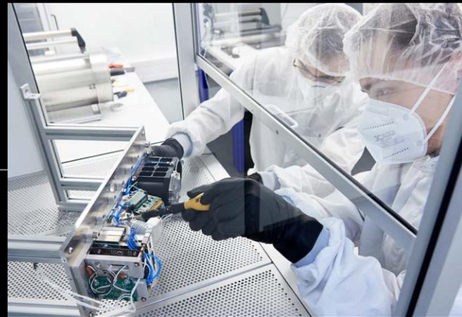
**Thermalinfrarot-Kamera »LisR«:** Das wissenschaftliche Instrument wurde 2023 auf der Internationalen Raumstation erprobt und lieferte eine Vielzahl hochaufgelöster bispektrale Wärmebilder von der Erde.
