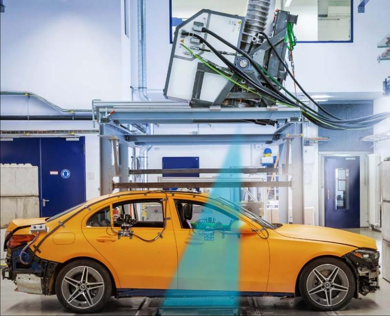
**Weltweit erster Röntgencrash – mit 1000 Bildern pro Sekunde:** Gemeinsam mit Mercedes-Benz hat das Fraunhofer EMI den weltweit ersten Röntgencrash durchgeführt. Zum Einsatz kommt ein Linearbeschleuniger mit rund 8 Millionen Elektronenvolt.
