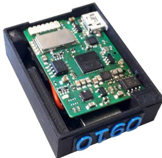
*Ein Lokalisierungs-Tag zur Lokalisierung von Warengütern und Geräten, der im Projekt MERLIN entwickelt und eingesetzt wird.*
