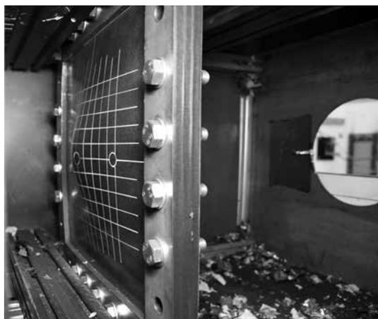
*Blick in den Prüfstand nach dem Impact einer Drohnenbatterie auf ein Aluminiumblech.*
