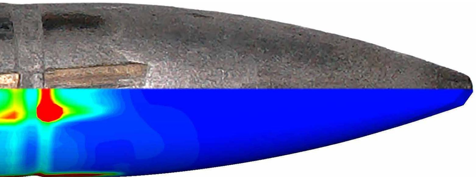
*Deformation eines Handwaffenprojektils nach dem Abschuss in Experiment und Simulation.*
