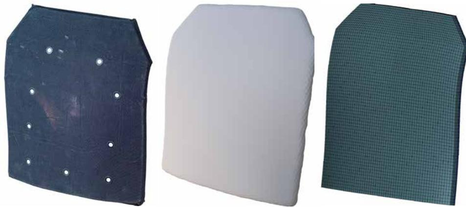
*Entwicklung vom FE-Modell des hartballistischen Teils der Körperschutzweste (von links nach rechts: reales Bauteil, 3D-Scan, FE-Modell).*
