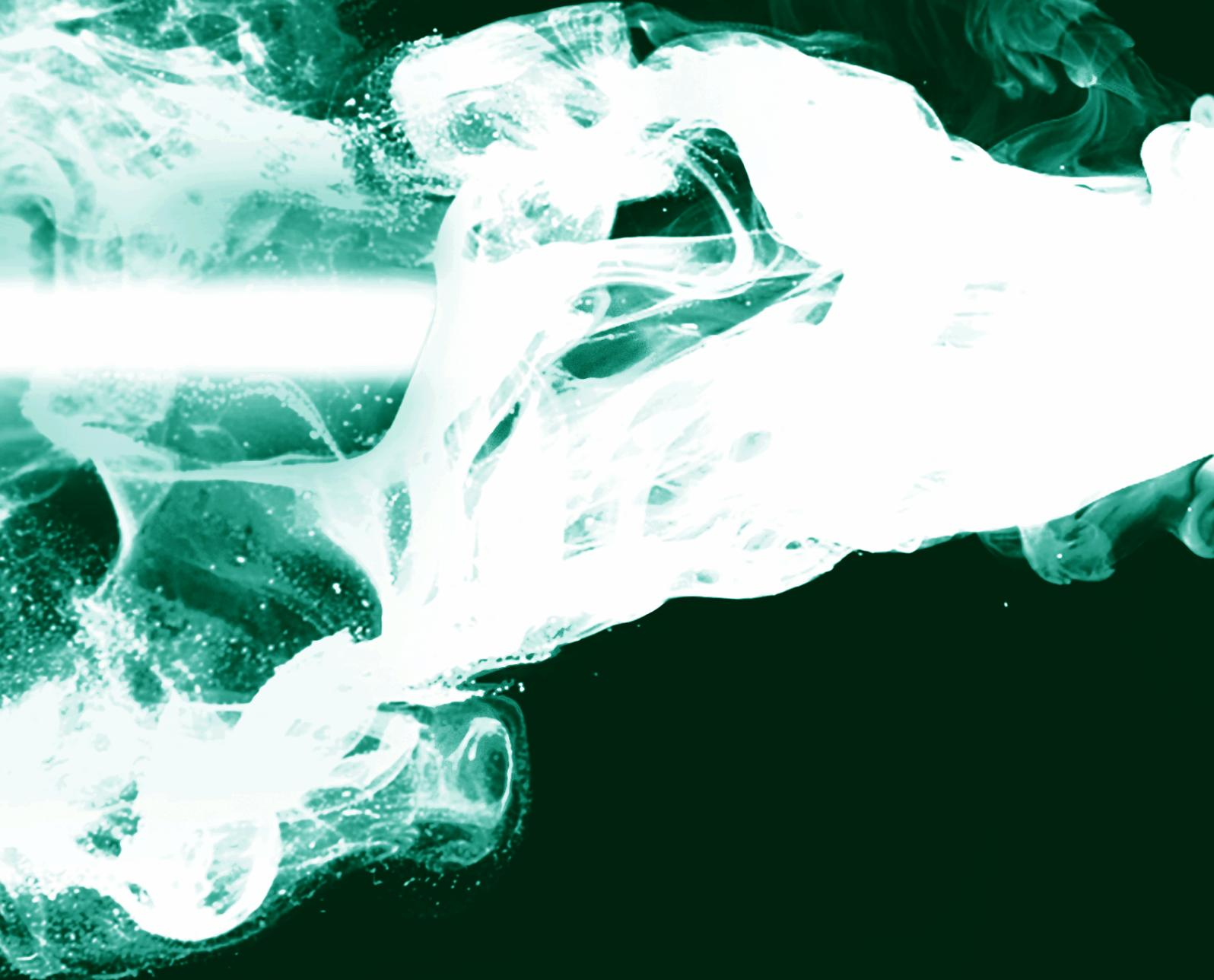
*Falschfarbendarstellung von Prozessleuchten bei der Perforation einer Platte aus kohlenstofffaserverstärktem Kunststoff durch einen Hochenergielaserstrahl. (Zur Verdeutlichung des Laserstrahls wurde dieser nachträglich verstärkt.)*
