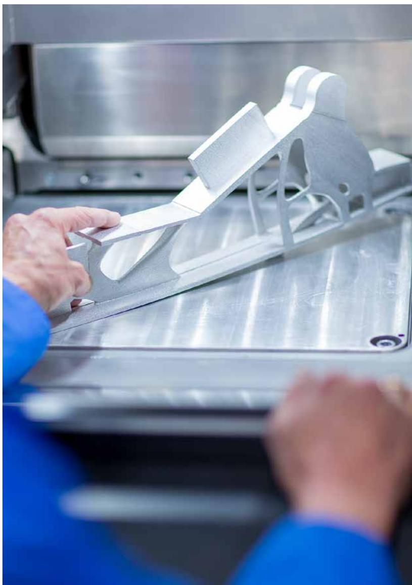
*Die im Lasersinterprozess hergestellte Leichtbaukomponente.*
