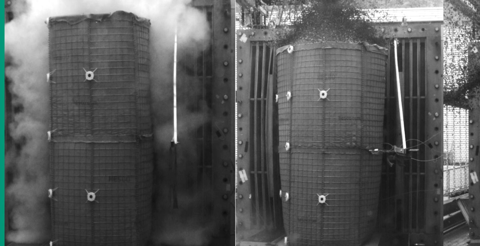
*Untersuchung des Strukturverhaltens eines erdbefüllten Schutzwalls in einem Stoßrohrversuch (Detonationseignis im Fernfeld).*
