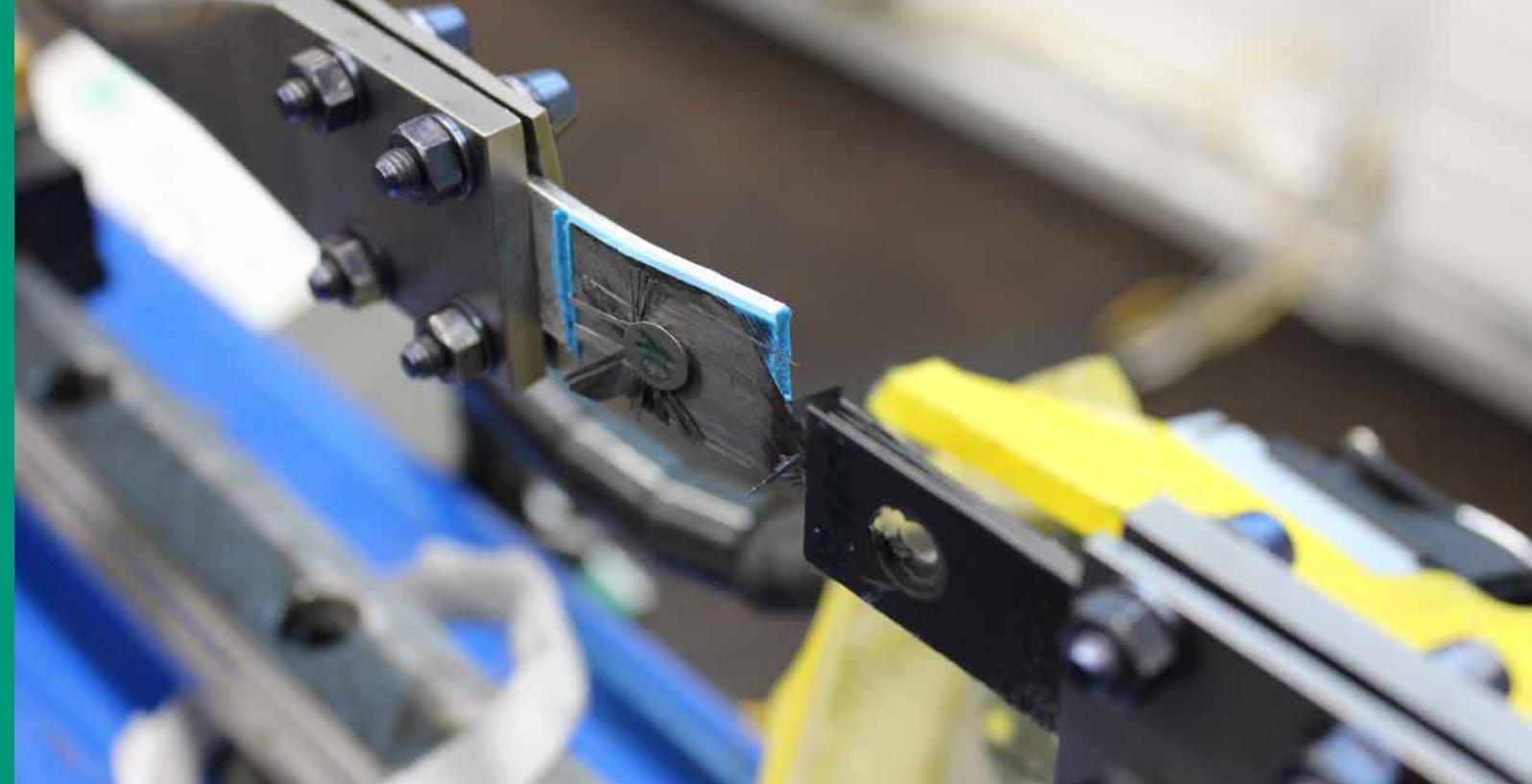
*Versagte geklebt-geschraubte Aluminium-CFK-Probe nach der Versuchsdurchführung am Split Hopkinson Tension Bar.*
