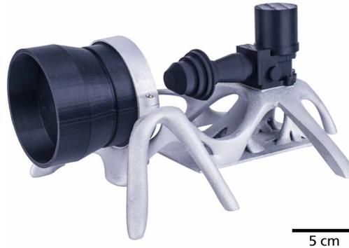
*Additiv gefertigte optische Bank der Infrarotnutzlast für den Nanosatelliten ERNST.*
