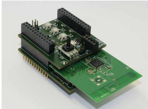
*Funksensorknoten für den Einsatz in U-Bahntunneln.*
