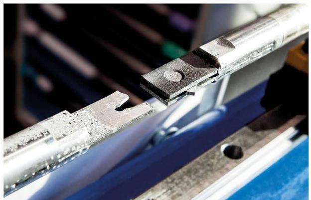
*2 Hybride Verbindung nach einem Zugversuche im Split Hopkinson Tension Bar bei zehn Metern pro Sekunde.*
