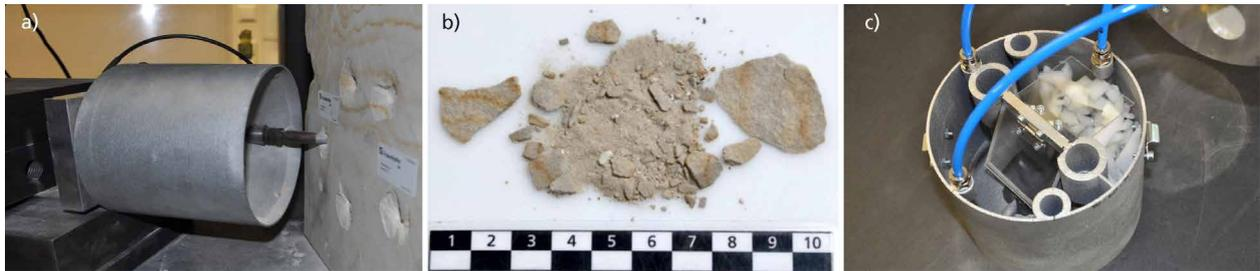
2 Leistungstest mit dem D-MEN: a) *Materialextraktion unter schrägem Winkel in einer Testkammer*, b) *extrahiertes Material*, c) *gesammeltes Material*.
