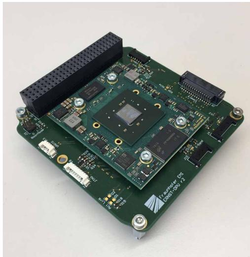
*Datenverarbeitungseinheit mit FPGA-Technologie.*
