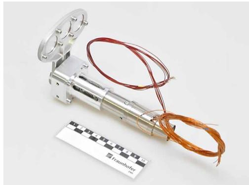
*Ingenieurmodell des Filterpendels für den Nanosatelliten ERNST.*
