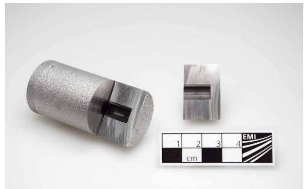
**2 Multimaterialstruktur: 3D-gedruckte Metallstruktur mit integriertem, konventionell hergestelltem Verbundwerkstoff (aufgetrennte Schnittansicht).**
