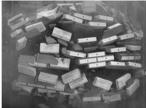
*Mauerwerksversuch an der Stoßrohranlage Blast-Star des Fraunhofer EMI.*
