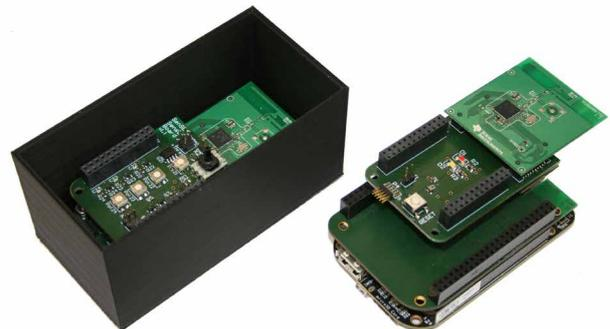
*2 Modular aufgebauter Sensorknoten mit Sensorboard (links) und Sinkknoten (rechts).*
